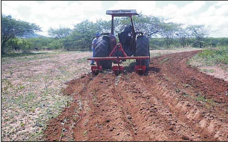
Foto 6 – Operação da Abertura de Sulcos em Nível, Seguindo um Sistema de Terraceamento Efetuado à Tração Motora
